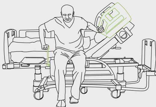
*Utilizando o controle integrado aos suportes Mobi-Lift®, o paciente pode ajustar a altura desejada da cama para se levantar.*
