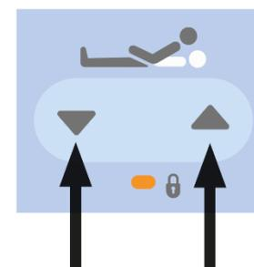
**OBSERVAÇÃO:** O ajuste do encosto é destravado automaticamente após 10 segundos enquanto o LED de travamento correspondente pisca lentamente, a menos que o travamento seja cancelado pela chave portátil.
