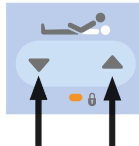
**OBSERVAÇÃO:** O ajuste do encosto é travado automaticamente após 10 segundos enquanto o LED de travamento correspondente pisca rapidamente, a menos que a trava seja confirmada pela chave portátil.
