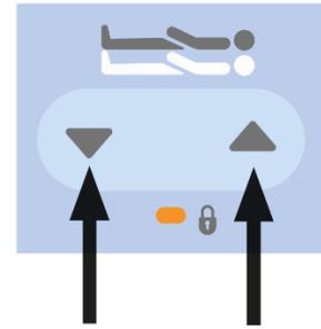
**OBSERVAÇÃO:** O ajuste da altura do leito, a inclinação Trendelenburg e a inclinação anti-Trendelenburg são travados automaticamente após 10 segundos enquanto o LED de travamento correspondente pisca rapidamente, a menos que o travamento seja confirmado pela chave portátil.
