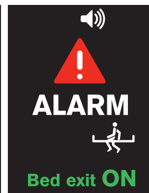
Fig. Sinalização visual do alarme de saída da cama (iBoard Basic)
