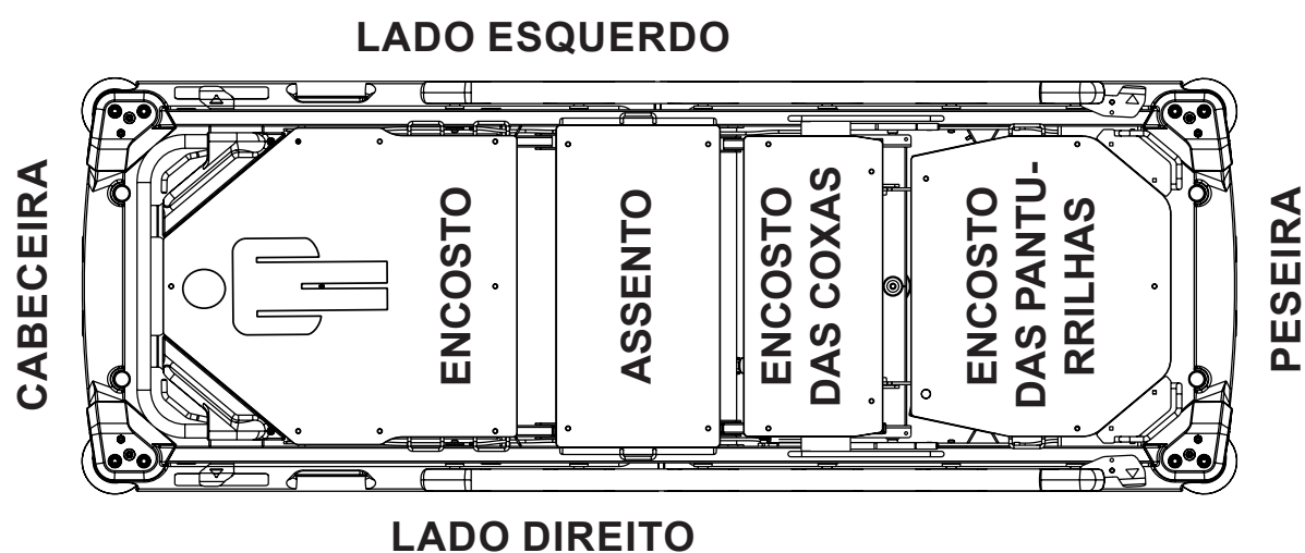
Fig. Plataforma do colchão em 4 partes
